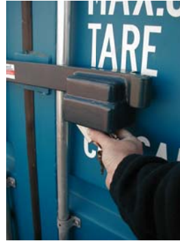
Kontroller at låsepinden er i indgreb med låsen efter nøglen er fjernet.
